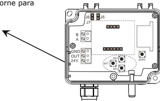
Nota2: O botão ZERO pode ser acionado pela tampa frontal. É utilizado para resetar o ponto ZERO. Outros botões e Jumpers estão localizados na placa interna, para ajustes é necessário a abertura do instrumento.
